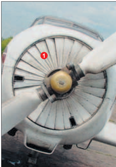
1. ЖАЛЮЗИ КАПОТА. ЗАКРЫВАЮТСЯ И ОТКРЫВАЮТСЯ ПО НЕОБХОДИМОСТИ.
