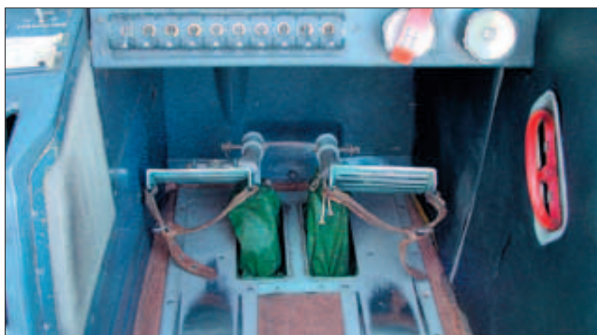
ПЕДАЛИ - СЛУЖАТ ДЛЯ УПРАВЛЕНИЯ РУЛЕМ НАПРАВЛЕНИЯ. НАД НИМИ СПРАВА СВЕРХУ КРАНЫ ПНЕВМОСИСТЕМЫ - ОСНОВНОЙ И ЗАПАСНОЙ (С КРАСНОЙ ПОЛОСКОЙ)
